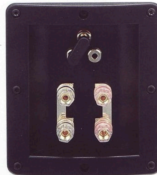
Das Terminal ist für Bi-Wiring und Bi-Amping ausgelegt, die steckbare Brücke dosiert feinfühlig den Hochtonpegel, falls der Raum obenrum unterdämpft ist.
