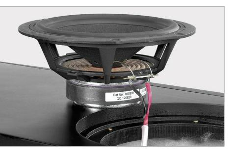
Links: Der 21-Zentimeter-Bass aus der HDS-Serie von Peerless hat einen Aluminium-Druckguss-Korb, eine belüftete Schwingspule und einen Nomex-Konus
