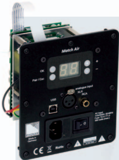
Das WISA-Empfangsmodul stammt wie das Hub von Hansong. Doch Phonar übernimmt nicht die Amps des Zulieferers, sondern verwendet Eigenentwicklungen.
