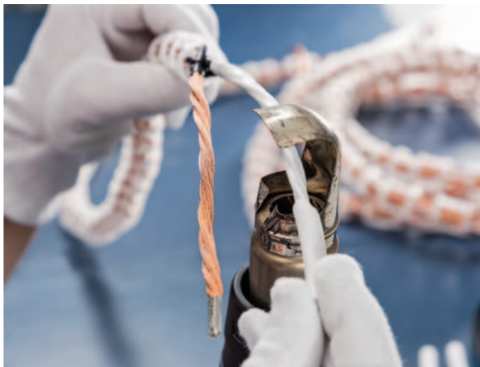
An den Enden werden die Kabel nochmals um sich selbst verdrillt und unter heißer Luft mit einem Schrumpf-Schlauch versiegelt.
