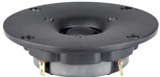
Der Hochtoner besteht aus einer beschichteten Gewebekalotte mit Schallführung und gekapseltem Gehäuse. Ferrofluid verbessert die Effizienz. Ungewöhnlich ist der Membrandurchmesser von 22 mm.
